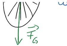
äußeres Drehmoment  $\vec{M} = \vec{r} \times \vec{F}_G = \frac{d\vec{L}}{dt}$
