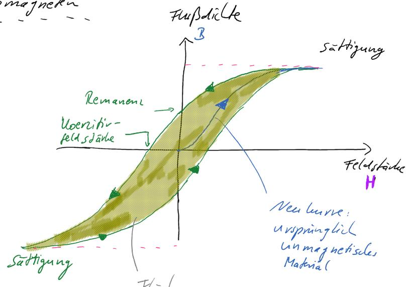
Entmagnetisierung durch mehrfaches Abfahren der Hysterese Kurve mit abnehmendem  $H_{max}$
